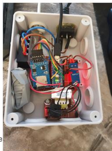
Рисунок – Структурная схема и внешний вид устройства регистрации мгновенных значений тока и напряжения
