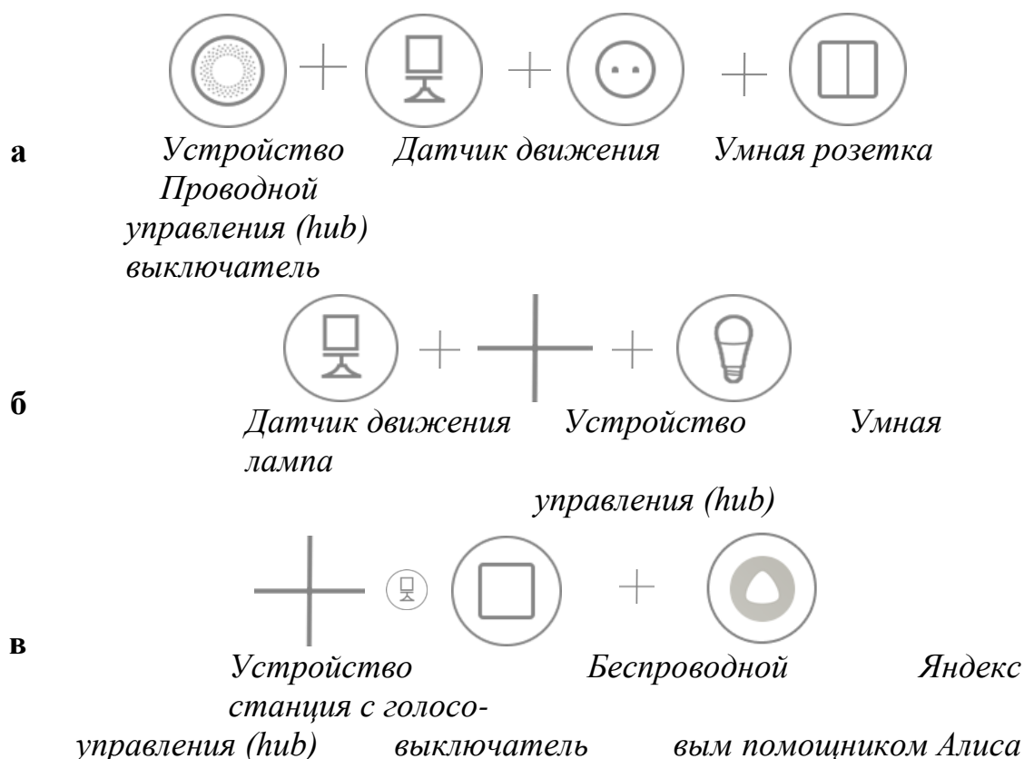
Рисунок – Некоторые простейшие варианты сочетаний устройств «умного» освещения а – позволяет задавать сценарии включения и выключения потолочного освещения и(или) настольных ламп, получающих питание через розетку, при входе человека в помещение или выходе из него; б – позволяет задавать сценарии работы «умной» лампы согласно показателям датчика движения; в – управление «умным» освещением при помощи беспроводного выключателя и голосового помощника.
