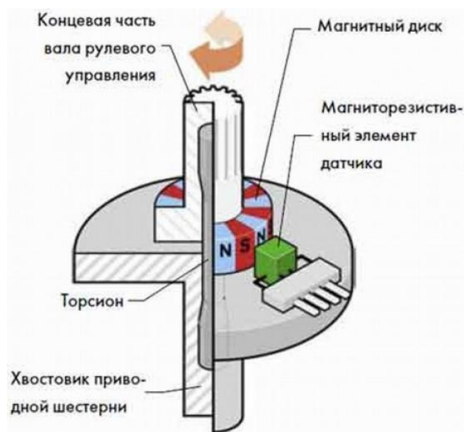
Рисунок 1 – Датчик Холла как элемент электронной системы автомобиля
