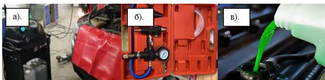
а). Аппаратная замена, б). Набор для вакуумирования СО, в). Частичная замена Рисунок – Способы замены охлаждающей жидкости
